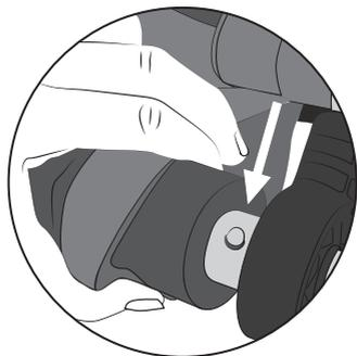
Расстегните липучку и отодвиньте прокладку в сторону. Отпустите кнопку нажатия пружины, чтобы затем раздвинуть трубки каркаса.
