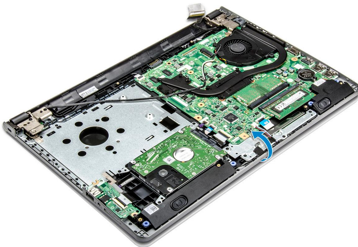
5 Снятие дисплея в сборе:
