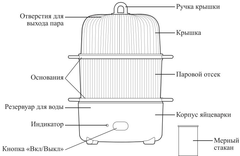
**Кнопка «Вкл/Выкл»** включает и выключает устройство. При включении устройства **индикатор** загорается, при выключении — гаснет.
