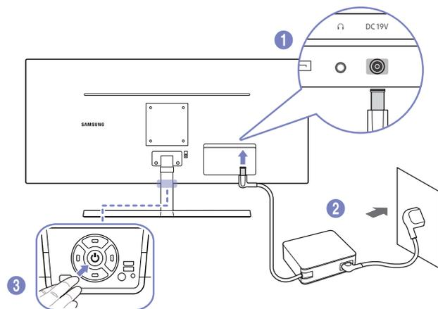
1 Подключите кабель питания к адаптеру постоянного/переменного тока. Затем подключите адаптер постоянного/переменного тока к порту постоянного тока DC19V на задней панели устройства.
