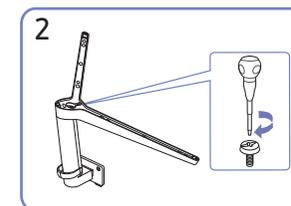
Полностью закрутите соединительный винт в нижней части подставки, чтобы как следует зафиксировать соединительный элемент. Затяните большой винт в середине, чтобы собрать конструкцию вместе.
