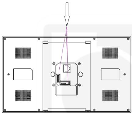
Подключите кабели от стены к соответствующим интерфейсам на задней крышке, чтобы проверить, работает ли устройство должным образом.
