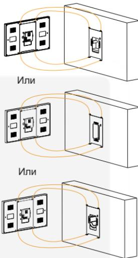
Наклоните устройство на 15° и выровняйте пазы на задней крышке с крючками на кронштейне.
