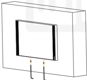
Используя шестигранный ключ, закрепите два винта M2x5 с шестигранной головкой в нижней части устройства.
