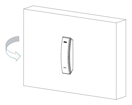
Совместите крепежные отверстия на задней стенке устройства с винтами в стене, а затем надавите на устройство, чтобы надежно закрепить его на стене.
