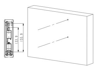
Согласно положению кабеля просверлите два отверстия в стене и убедитесь, что расстояние между этими отверстиями соответствует указанному на рисунке измерению
