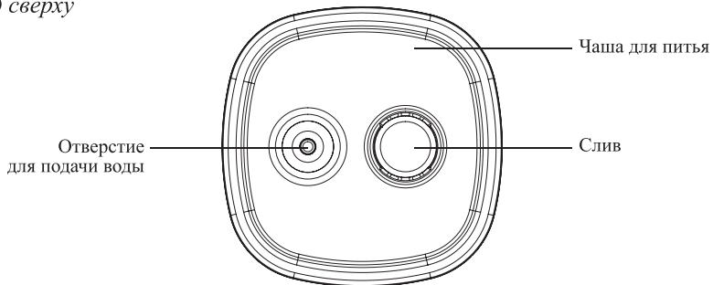
Принцип работы фонтанчика для животных прост. Водяной **насос** перекачивает воду из **резервуара для воды** в **чашу для питья**. **Трубка для подачи воды** соединяет насос с чашей для питья и направляет струю воды в **воронку**. На чаше для питья предусмотрено **отверстие для подачи воды**, через которое вода вытекает в чашу. Через **слив** вода стекает, проходя через фильтр, обратно в резервуар для воды.
