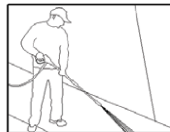
Рис. 6. Оптимальный угол относительно очищаемой поверхности
