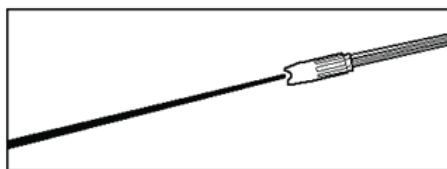
Рис. 3. Узкая струя с высокой ударной нагрузкой
