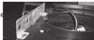
4. Установка крепёжной скобы декоративного короба. Для установки крепления декоративного короба просверлите два отверстия в месте предполагаемого крепления короба вытяжки. Зафиксируйте крепёжную скобу с помощью крепёжных элементов, поставляемых в комплекте.
