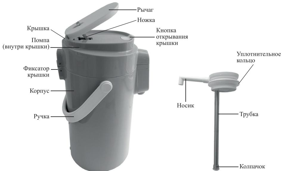
В колбу термоса опускается *трубка*, на конце которой предусмотрен *колпачок* для защиты колбы от царапин. Трубка соединяется с *носиком*, через который напиток выливается из колбы.
