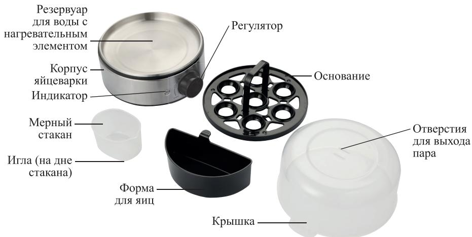
**Регулятор** включает и выключает устройство, а также позволяет выбрать время до 30 минут/степень приготовления яиц: ○ — яйцо всмятку, ● — яйцо в мешочек, ●● — яйцо вкрутую.
