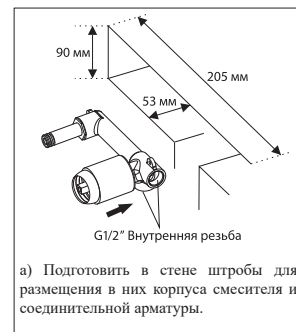
б) Разместить в штробе корпус смесителя, подключить его к трубопроводу. Далее установить декоративную накладку.
