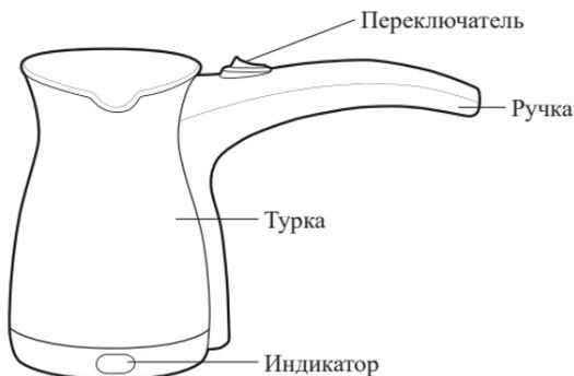
**Переключатель** на базе включает и выключает электрическую турку. Переведите переключатель в положение «В», чтобы включить турку, и в положение «О» — чтобы выключить. Турка не отключается автоматически. **Индикатор** горит, когда устройство включено.
