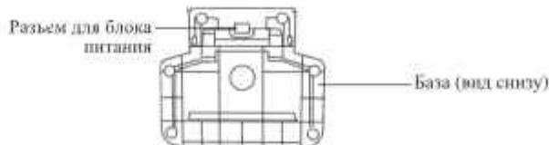
Аккумулятор устройства расположен в ручном модуле. Убедитесь, что ручной модуль установлен в корпус моющего пылесоса, и установите прибор на базу. Уровень заряда в процентах будет мигать на дисплее моющего пылесоса. Время полной зарядки аккумулятора составляет 4–5 часов. Когда на дисплее отобразится «100», аккумулятор будет полностью заряжен.
