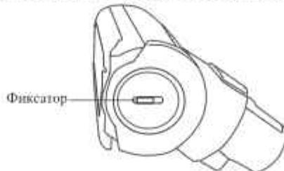
2. Выньте фиксатор. Аккуратно сдвиньте валик в сторону и выньте через отверстие фиксатора.
