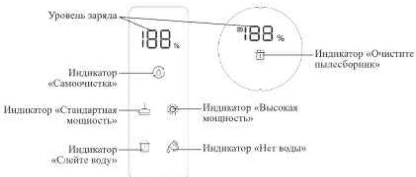
Нажатие на кнопку «Вкл/Выкл» на удлинительной ручке включает моющий пылесос и переключает мощность работы. Чтобы включить устройство, выведите его из положения вертикальной парковки и нажмите на кнопку «Вкл/Выкл» на удлинительной ручке один раз. При включении пылесоса на дисплее загорается **уровень заряда** в процентах и **индикатор «Стандартная мощность»**.
