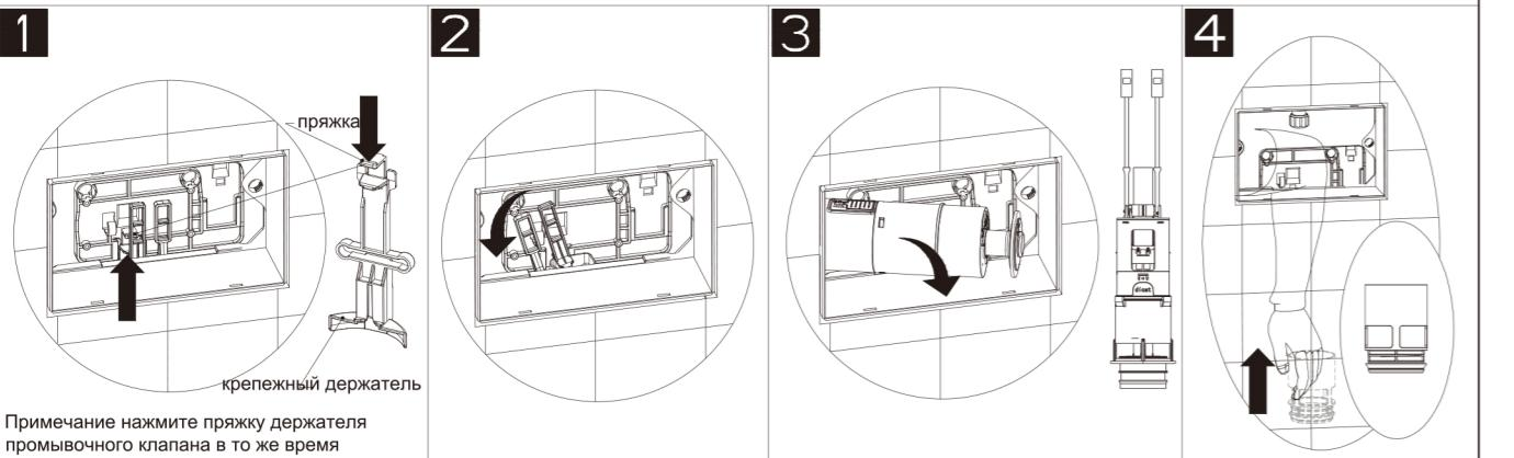
Примечание: нажмите на пряжку держателя промывочного клапана в то же время выдвинуть флеш клапан.
