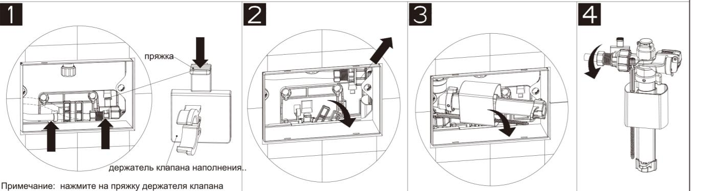
Примечание: нажмите на пряжку держателя клапана наполнения, одновременно выдвинув клапан наполнения.
