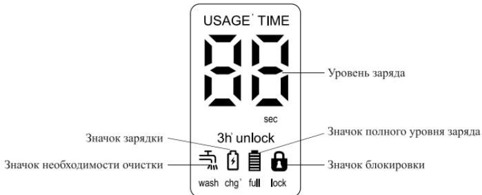
**Кнопка включения** служит для включения и выключения устройства. Нажмите и удерживайте кнопку включения в течение 3 секунд, чтобы включить блокировку от случайного включения прибора. При включении блокировки в течение 3 секунд будет **мигать значок блокировки**, затем индикация погаснет. Чтобы отключить данную функцию, нажмите и удерживайте кнопку включения в течение 3 секунд.
