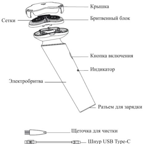
**Кнопка включения** служит для включения и выключения устройства.
