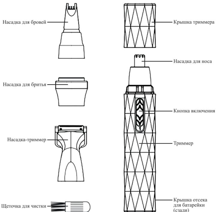
**Кнопка включения** включает и выключает триммер.
