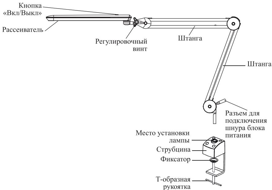
**Кнопка «Вкл/Выкл»** включает и выключает прибор, а также настраивает яркость света. Лампа имеет 4 уровня яркости: 100%, 75%, 50%, 25%.
