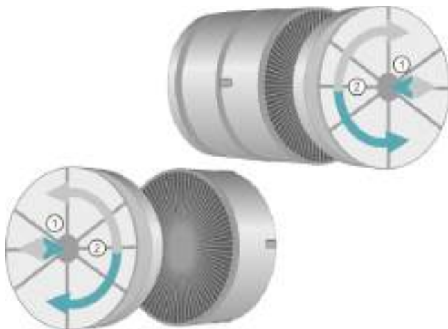
Рис. 14 Установка угольного фильтра
