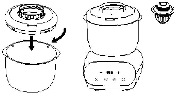
В крышке чаши есть загрузочное отверстие, с помощью которого можно добавить ингредиенты в чашу во время работы прибора. Чтобы открыть загрузочное отверстие, поверните ручку чаши против часовой стрелки и вверх.
