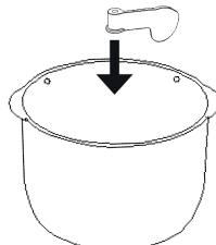
*Установка чаши.* Поставьте чашу на вал моторного блока, затем поверните чашу по часовой стрелке до упора. Чаша зафиксируется на моторном блоке. Для снятия чаши поверните ее против часовой стрелки и поднимите.
