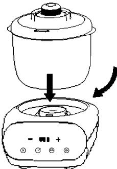
*Крышка чаши* предотвращает разбрызгивание ингредиентов во время работы прибора. Установите крышку на моторный блок так, чтобы выступы на крышке попали в пазы на моторном блоке, и поверните ее по часовой стрелке. Убедитесь, что крышка закреплена на устройстве. Чтобы снять крышку, поверните ее против часовой стрелки и потяните вверх.
