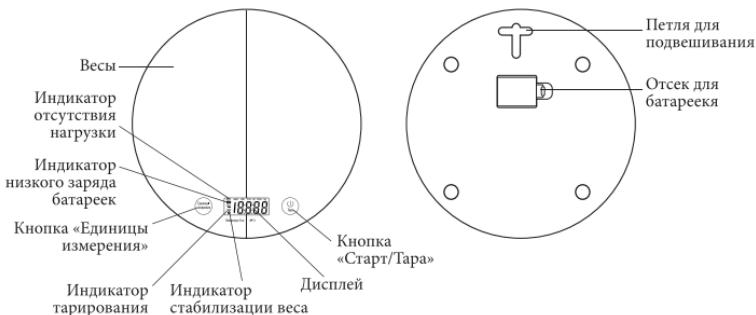
**Кнопка «Старт/Тара»** включает и выключает весы, а также включает функцию тарирования. Чтобы включить весы, нажмите и удерживайте кнопку «Старт/Тара».
