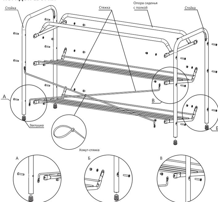
**Рис. 1** Сборка каркаса
