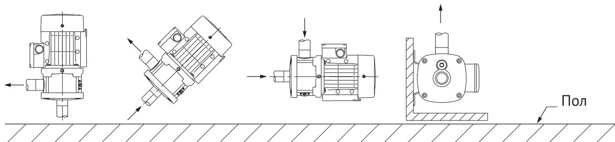
*Рисунок 1. Допустимые положения насоса.*
