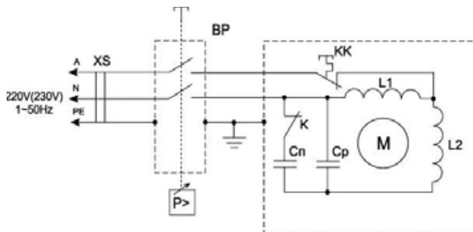
Для исполнения электродвигателя без пускового конденсатора
