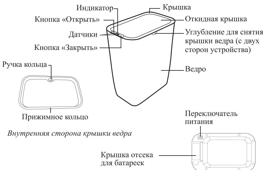
**Переключатель питания** включает и выключает работу датчиков и кнопок. Переведите переключатель в положение «I» для включения датчиков и кнопок, и в положение «O» для выключения.
