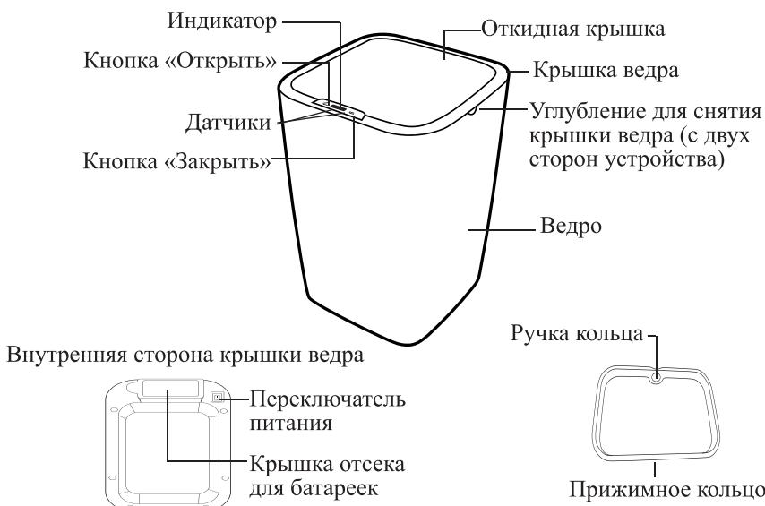
**Переключатель питания** включает и выключает работу датчиков и кнопок. Переведите переключатель в положение «I» для включения датчиков и кнопок, и в положение «O» для выключения.
