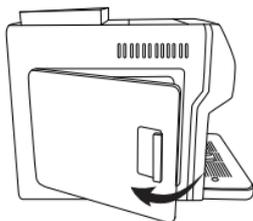
2. Извлеките резервуар для воды, наполните его водой до отметки MAX и установите его обратно.
