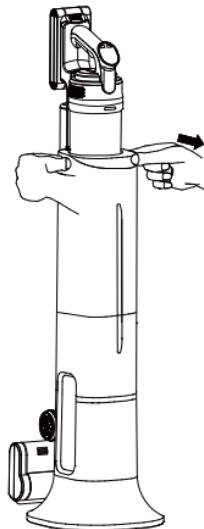
2. Нажмите на кнопку дверцы отсека мешка-пылесборника (36) и откройте дверцу отсека мешка-пылесборника, опустив ее вниз.
