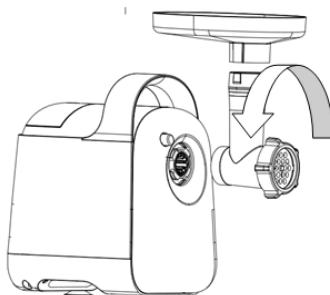
2. Установите собранную приемную камеру с горловиной для размельчения мяса в основную машину как показано на рисунке. Для этого нажмите большим пальцем одной руки на кнопку фиксации, а другой рукой держите приемную камеру с горловиной для размельчения мяса, вставьте ее в отверстие основной машины и поворачивайте против часовой стрелки до тех пор, пока она не перестанет двигаться.
