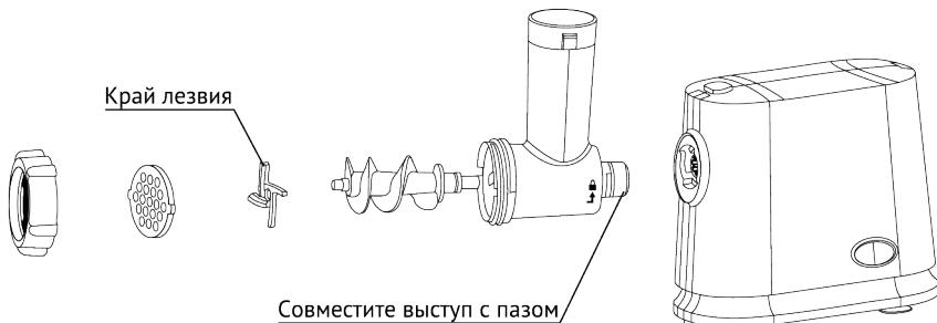
**ПРИМЕЧАНИЕ:** при сборке следите за тем, чтобы плоская режущая часть ножа была обращена к решетке и плотно к ней прилегала. Если лезвие установить не правильно, режущей кромкой вовнутрь, устройство не сможет перерабатывать мясо и моментально забьется.
