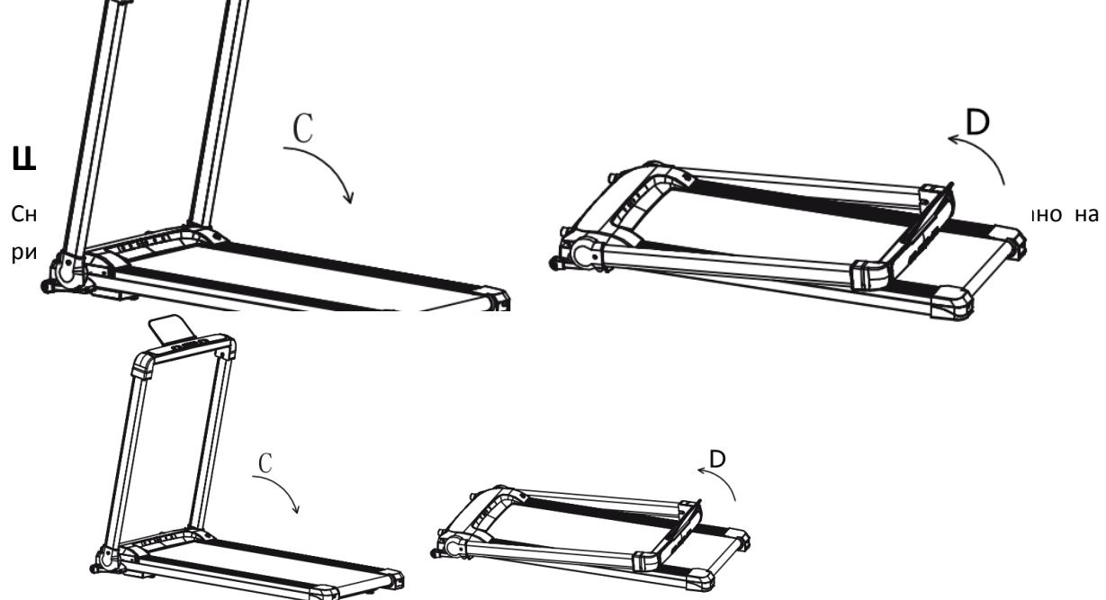
Переведите тренажёр в вертикальное положение. Для опоры конструкции раскройте ножку, переведя её в положение F (см. рисунок).
