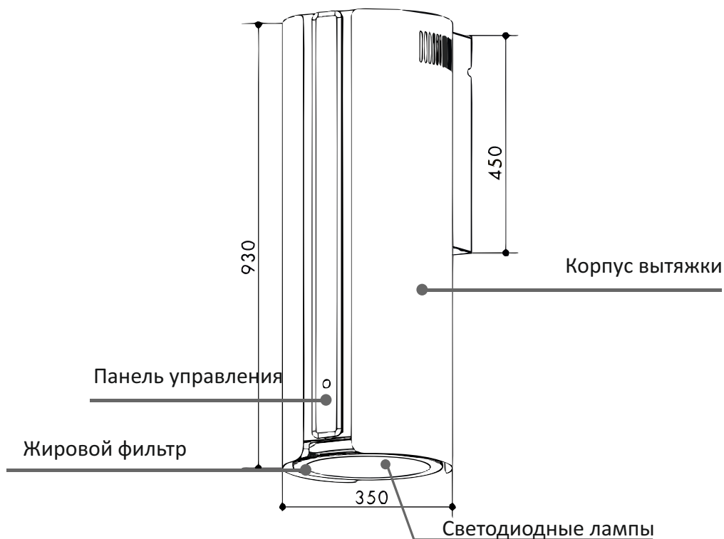
Рис.2 Наружная часть вытяжки состоит из следующих составных частей
