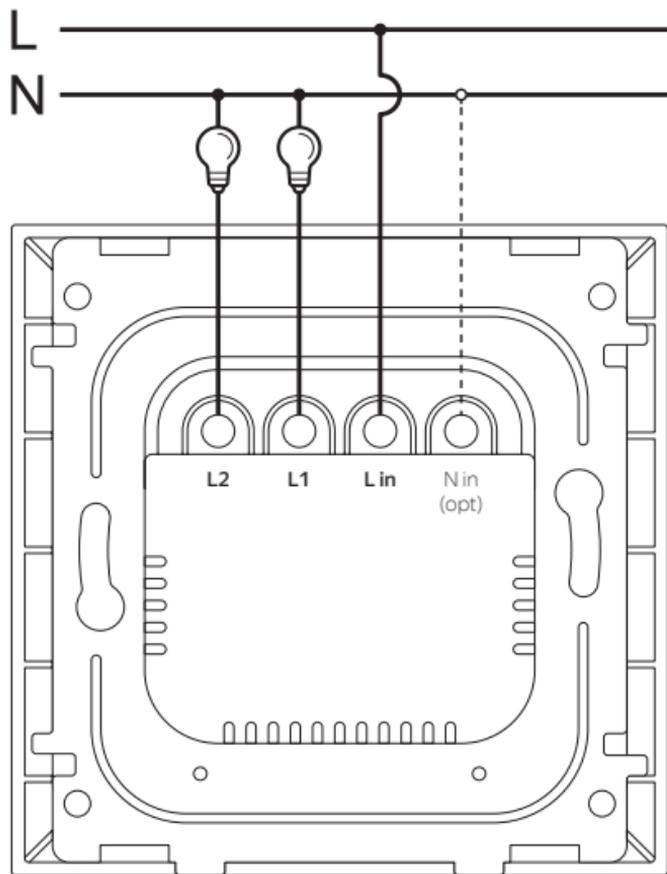
4 Используя отвёртку, подключите выключатель по схеме:
