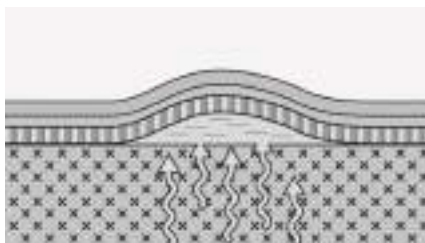
Рис. 9. Следствие избыточной влажности основания
