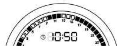
После установки текущего времени, в режиме «Таймер» можно настроить время остановки котла по часам в течение суток. Это позволит дополнительно экономить газ в то время, когда дома никого нет.
