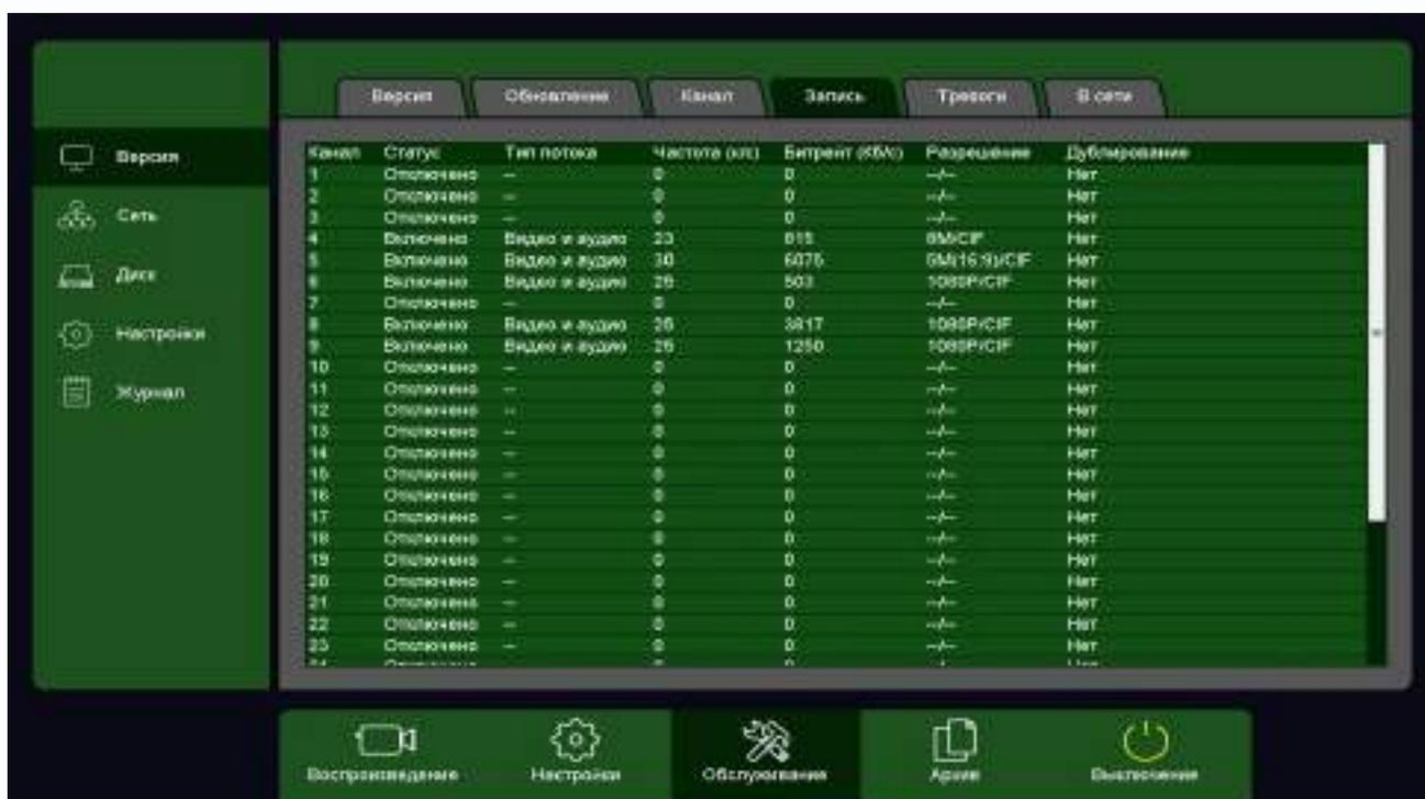
В данном меню отображается текущий статус камер, поток записи – только видео или видео и аудио, частота к/с, битрейт камер, разрешение камер, дублирование записей от камер.
