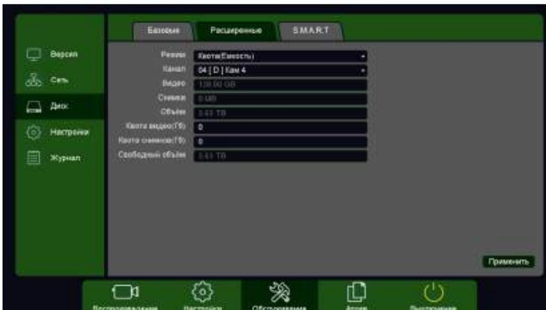
В этом режиме для камер можно назначить объем дискового пространства в гигабайтах, на которое камера будет осуществлять запись.
