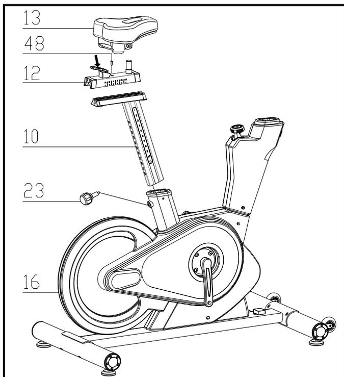
Установите вертикальную стойку сиденья (10) на корпус основной рамы (16). Затем установите направляющую сиденья (12) на вертикальную стойку (10), закрепите детали с помощью болта (48). Ослабьте регулировочную ручку (23) и вытяните назад, а затем отрегулируйте высоту сиденья. Вставьте регулировочную ручку на место и снова затяните.
