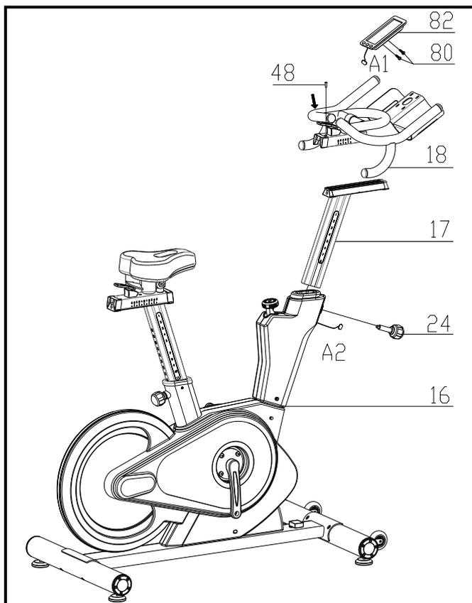
Установите стойку руля (17) на основную раму (16). Сначала нужно ослабить регулировочную ручку (24) и вытянуть назад, а затем отрегулировать высоту руля. Вставьте регулировочную ручку на место и снова затяните. Затем установите и закрепите руль (18) на стойке руля (17) с помощью болта (48).
