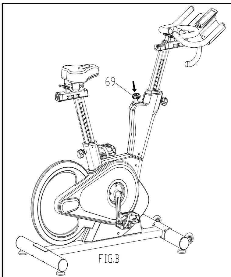
Та же ручка, которая позволяет регулировать натяжение спин-байка, также выполняет функцию аварийного торможения. Используйте данную функцию в любой ситуации, когда необходимо внезапно сойти с тренажера и/или остановить маховик. Чтобы использовать функцию аварийного торможения, сильно нажмите на ручку управления аварийным тормозом и натяжением (#69).
