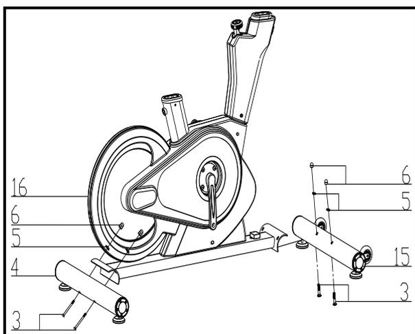
Установите передний стабилизатор (15) и задний стабилизатор (4) на основную раму (16), затем закрепите с помощью плоской шайбы (5) и болтов (3).
