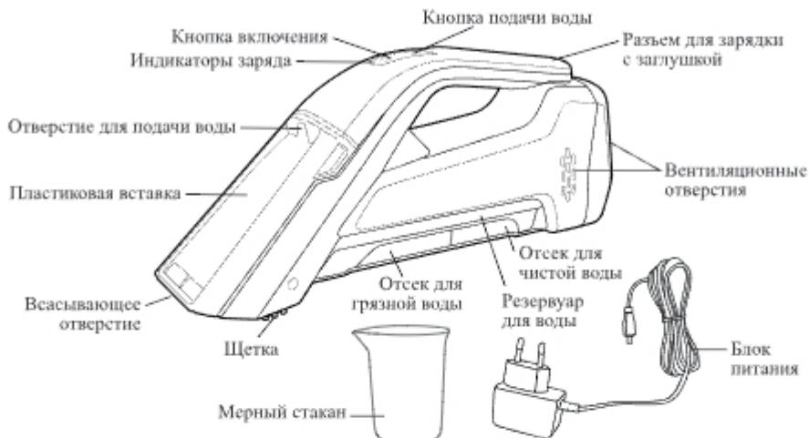
**Кнопка включения** включает и выключает прибор. После нажатия на кнопку включения загорается подсветка, а также на секунду загораются зеленым три индикатора заряда над кнопкой включения. Затем в зависимости от уровня заряда горят зеленым три, два или один индикатор. Когда прибор необходимо зарядить, один индикатор мигает красным, остальные индикаторы не горят.
