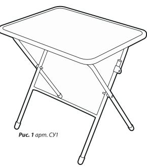
Перед эксплуатацией следует ознакомиться с паспортом и руководством по эксплуатации. Следуя инструкции, выполните установку стола.
