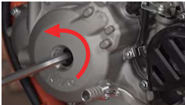
Фото 5.37. Направление вращения коленчатого вала.
