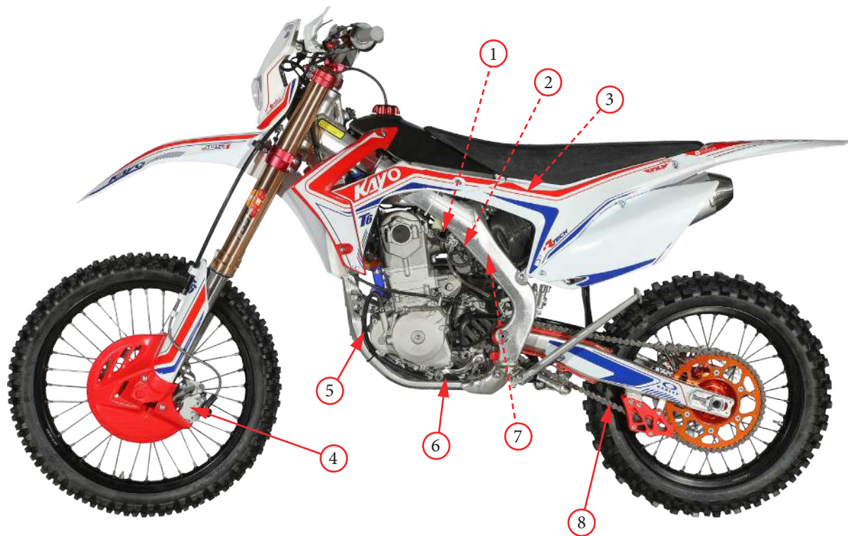
Фото 4.2. Узлы и механизмы левой стороны: 1 – рычаг обогатителя топливной смеси; 2 – регулятор частоты холостых оборотов; 3 – воздушный фильтр; 4 – суппорт переднего тормоза; 5 – патрубок вентиляции картера; 6 – болт слива масла; 7 – регулятор пружины задней подвески; 8 – приводная цепь.
