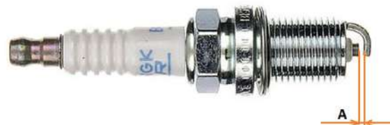
Фото 5.16. Зазор между электродами свечи зажигания.
