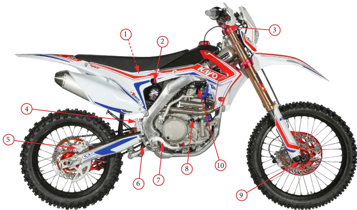
Фото 4.3. Узлы и механизмы правой стороны: 1 – аккумуляторная батарея; 2 – регулятор степени сжатия задней подвески; 3 – регулятор степени сжатия/отбоя передней подвески (в зависимости от модели); 4 – бачок жидкости заднего тормоза; 5 – суппорт заднего тормоза; 6 – регулятор степени отбоя задней подвески; 7 – педаль заднего тормоза; 8 – крышка маслозаливной горловины; 9 – регулятор степени отбоя/сжатия передней подвески (в зависимости от модели); 10 – свеча зажигания.
