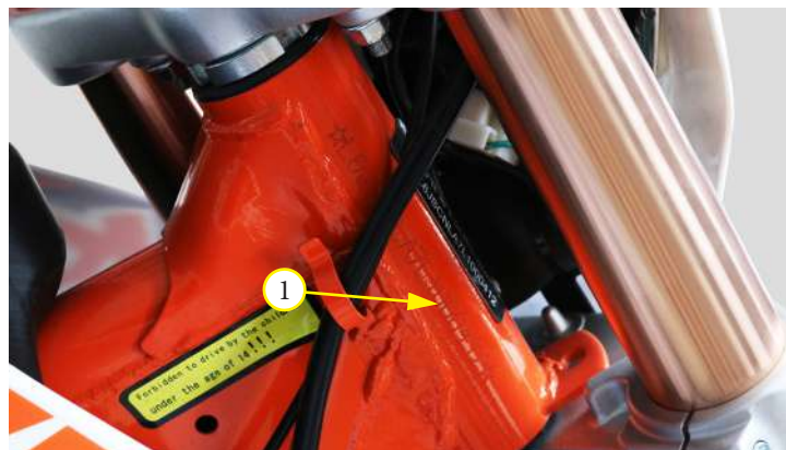
Фото 1.3. Место расположения серийного номера (VIN) – 1.
