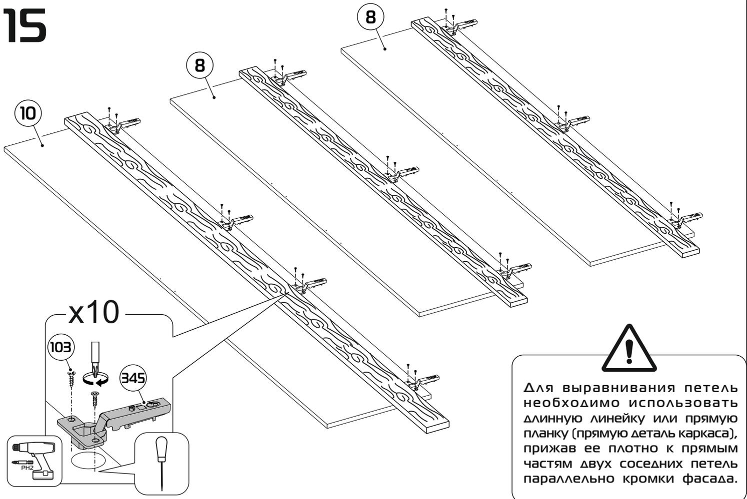
Для выравнивания петель необходимо использовать длинную линейку или прямую планку (прямую деталь каркаса), прижав ее плотно к прямым частям двух соседних петель параллельно кромки фасада.
