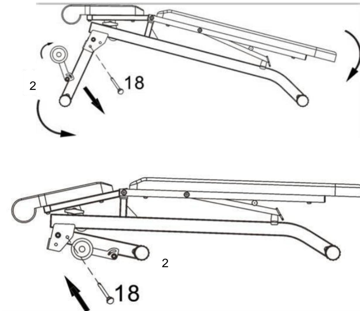
Выньте штифт (18) и сложите переднюю опорную конструкцию к раме (1), как показано на рисунке. Вставьте штифт (18) в соседнее отверстие для фиксации тренажёра в сложенном положении.
