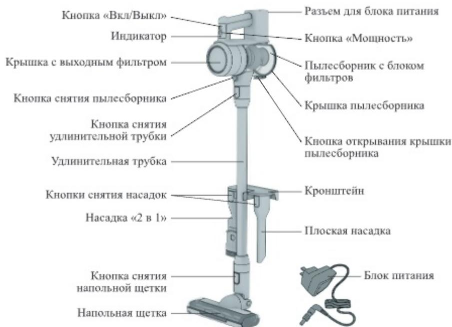
**Кнопка «Вкл/Выкл»** включает и выключает пылесос.
