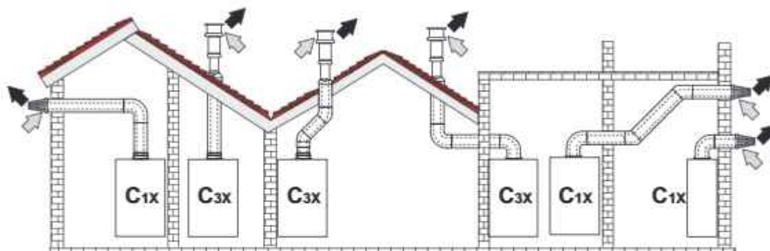
рис. 27- Примеры подсоединения с помощью коаксиальных труб (→ = Воздух/ → = Дымовые газы)
