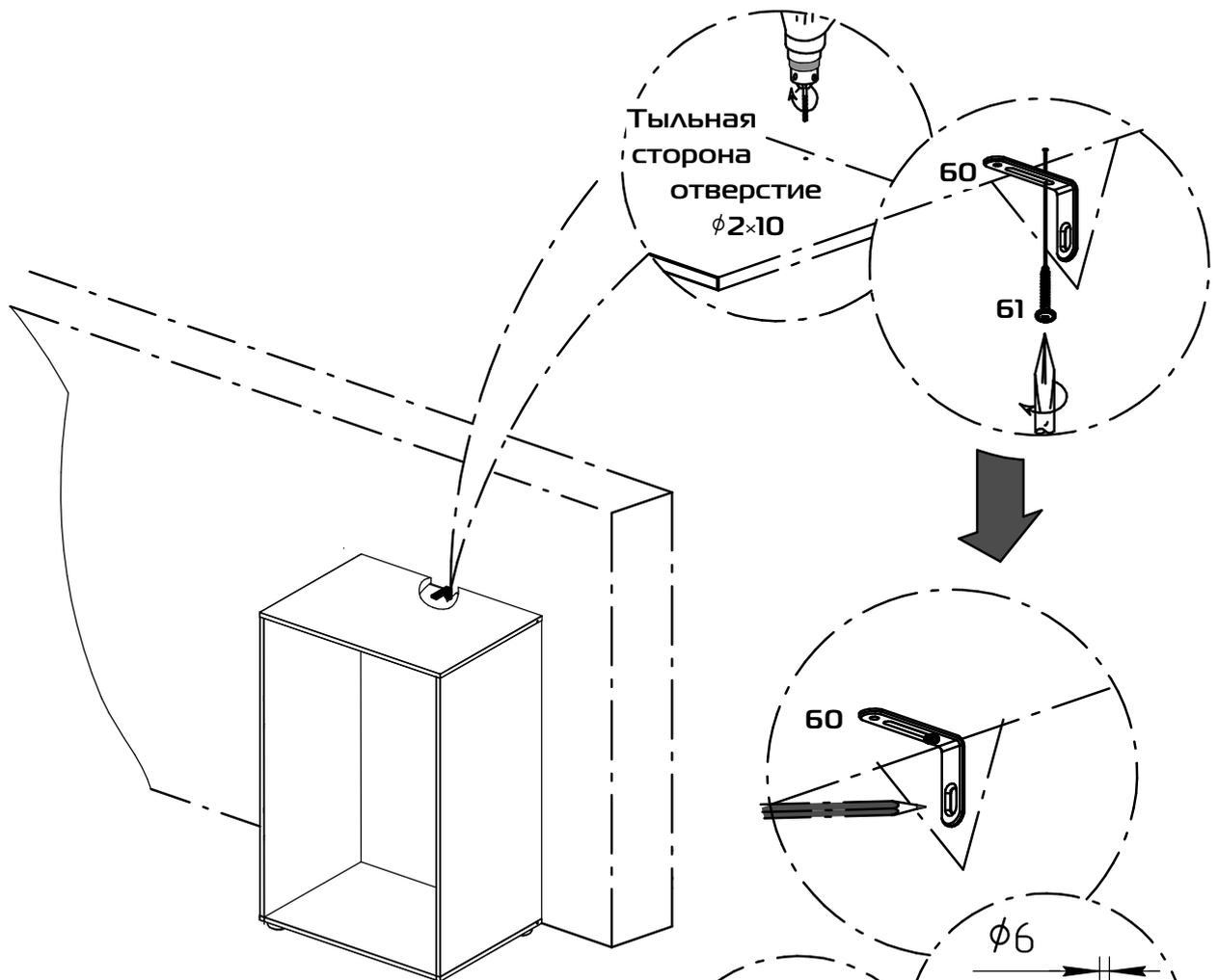
**Внимание! Уголок установить подкрышку. Сделать вырез в дет. 05 как показано в шаг 15, для прилегания уголка к стене.**
