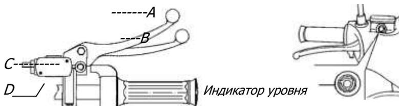
7.5.2.2 если свободный ход не в пределах 10-20 мм и рычаг подачи жидкости находится ниже нижней отметки уровня в окне просмотра, следует повернуть гайки C,D. Затем указанная тормозная жидкость должна быть добавлена в бак тормозной жидкости.
