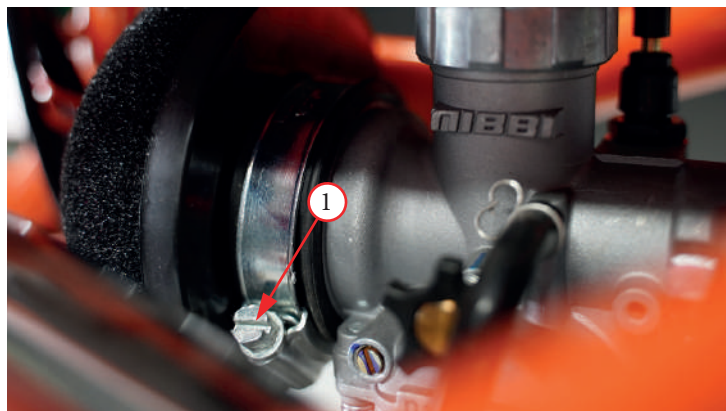
Фото 5.6. Крепление воздушного фильтра
