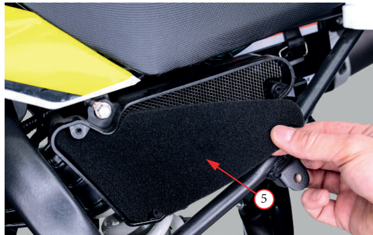
Фото 5.7. Обслуживание воздушного фильтра закрытого типа
