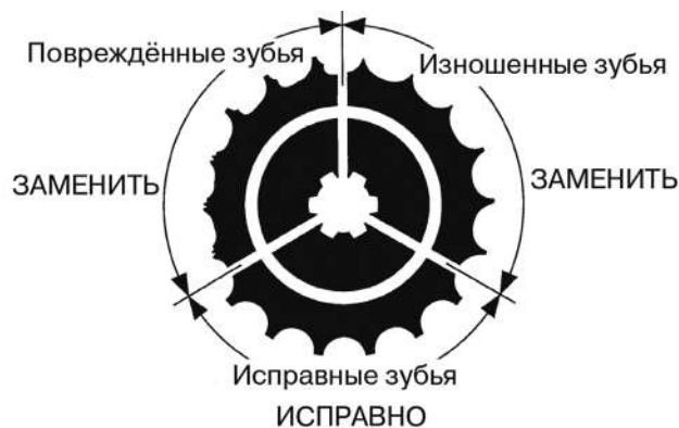
Рисунок 5.24. Вид зубьев звездочки
