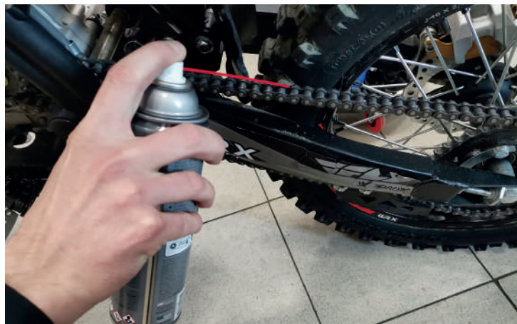
Фото 5.27. Очистка и смазка цепи
