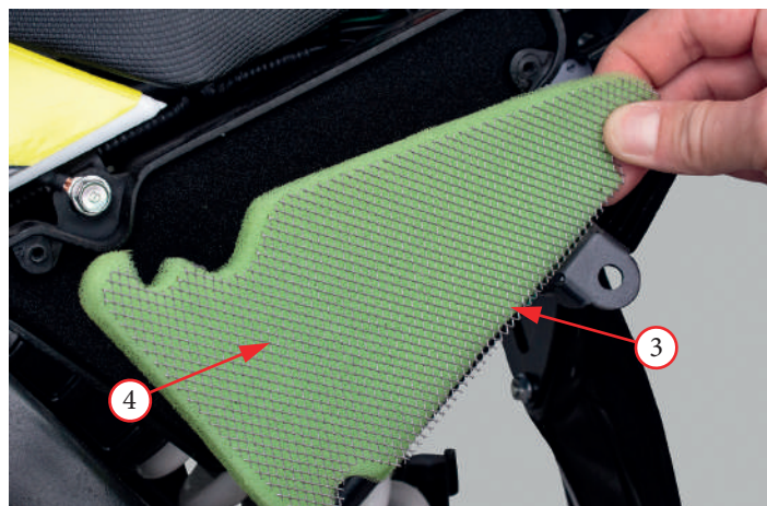
Фото 5.7. Обслуживание воздушного фильтра закрытого типа
