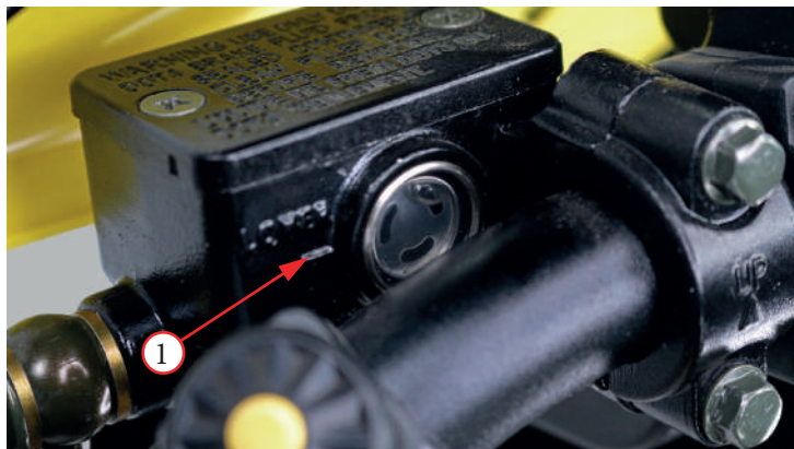
Фото 5.17. Уровень тормозной жидкости в переднем и заднем контуре
