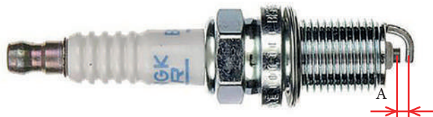
Фото 5.14. Зазор свечи зажигания – А
