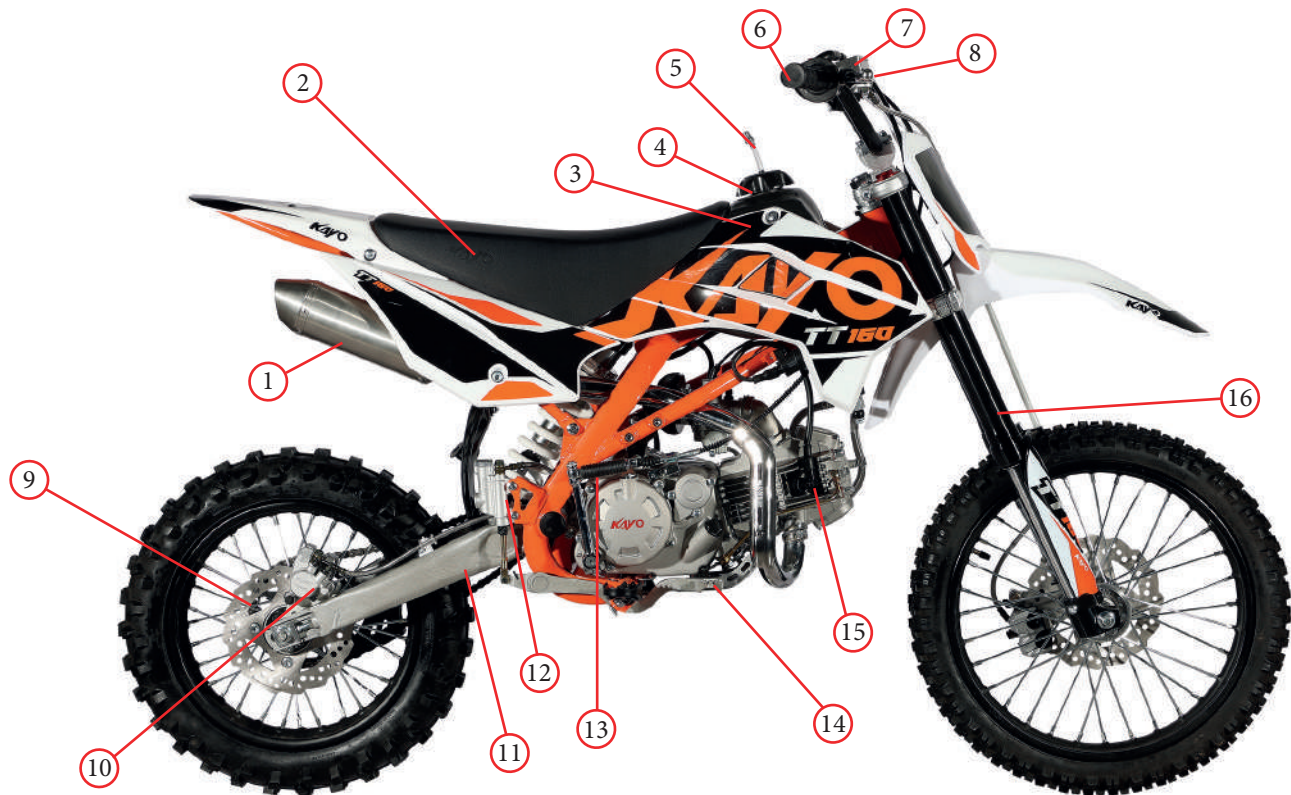
Фото 2.2 Правая сторона питбайка: 1 – глушитель; 2 – сиденье; 3 – топливный бак; 4 – крышка бака; 5 – вентиляционная трубка; 6 – ручка акселератора (газа); 7 – передний бачок тормозной жидкости; 8 – рычаг переднего тормоза; 9 – задний тормозной диск; 10 – задний тормозной суппорт; 11 – задний маятник; 12 – задний тормозной цилиндр; 13 – рычаг кик-стартера; 14 – педаль заднего тормоза; 15 – колпак свечи зажигания; 16 – передний амортизатор
