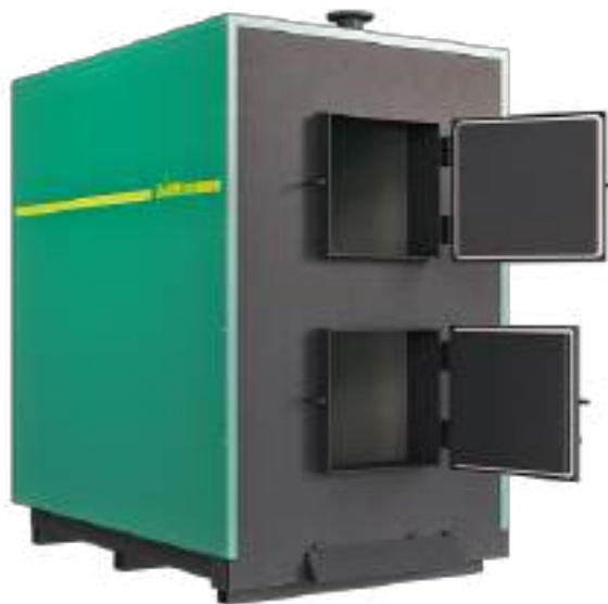
Котел Lavoro PRO это современный стальной водогрейный котел, предназначен для отопления помещений, оборудованных системами водяного отопления с естественной или принудительной циркуляцией, и горячего водоснабжения (ГВС), с рабочим давлением до 0,45 МПа и максимальной температурой на выходе из котла до 95°C. Котел Lavoro PRO работает на различных видах твердого топлива, а именно на дровах, топливных брикетах, угле, торфяных брикетах.
