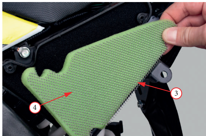
Фото 5.7. Обслуживание воздушного фильтра закрытого типа
