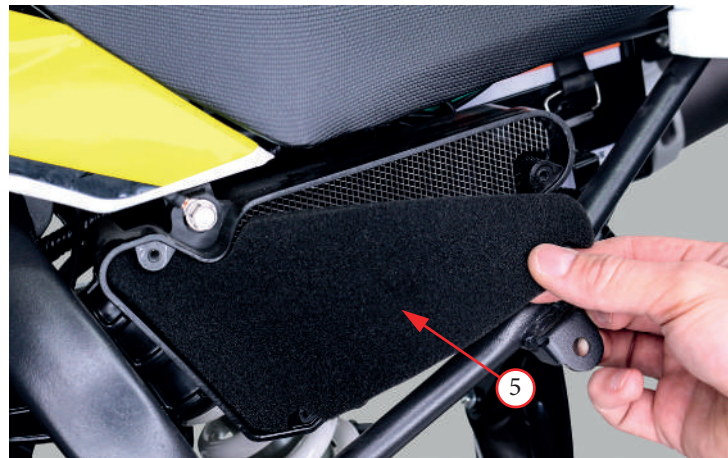
Фото 5.7. Обслуживание воздушного фильтра закрытого типа
