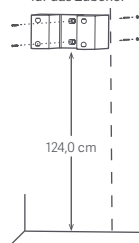
Installation der Wandhalterung für das Zubehör
